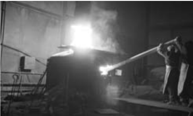
Vermischen der Bronzeschmelze mit einem Fichtenstamm
